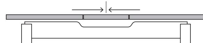
2. За любую половину сдвинуть столешницу до соединения со вставкой.
